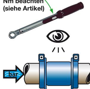
Schrauben mit Drehmomentschlüssel anziehen
