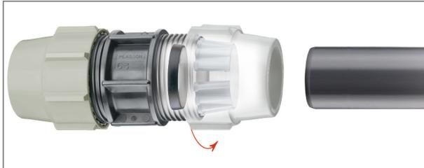
Rohrende mit einem Rohrschneider rechtwinklig abschneiden, entgraten und mit einem Anfasgerät abschrägen. Überwurfmutter bis zum letzten Gewindegang lösen.
