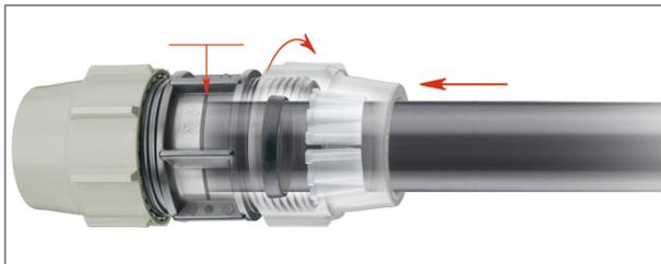
PE-Rohr mit trinkwassertauglichem Gleitmittel oder Wasser einschmieren bzw. befeuchten und bis zum Anschlag in den Fitting einschieben.
