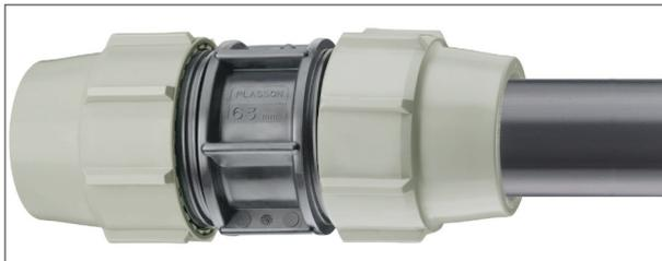
Überwurfmutter mit dem PLASSON-Schlüssel kräftig anziehen. (Bei Fittings bis 32 mm ist ein Anziehen auch per Hand möglich.)
